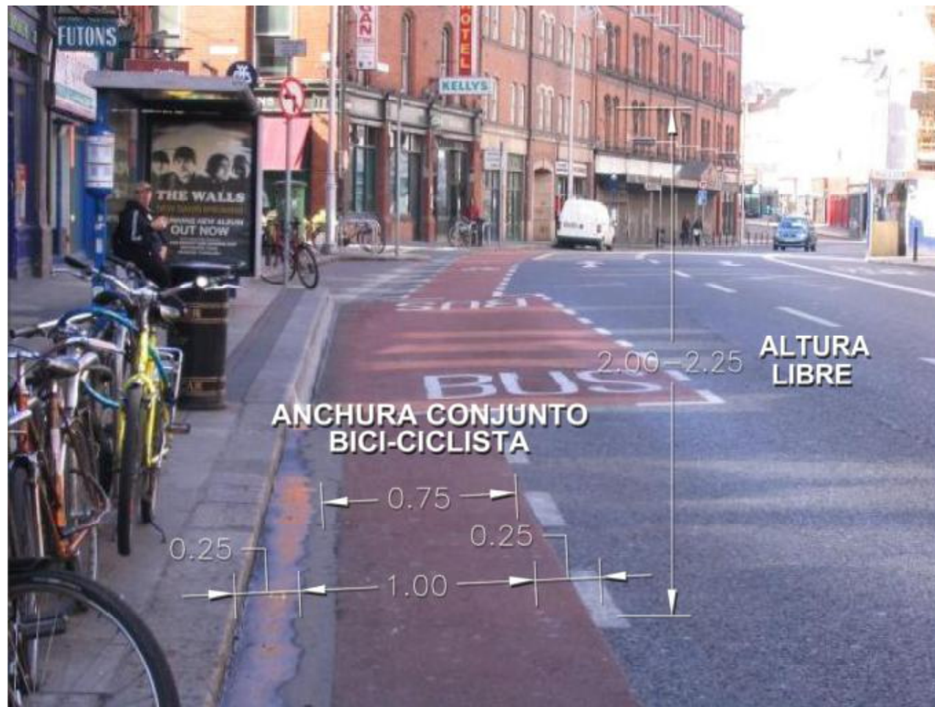
Imagen 26. Dimensiones mínimas en vías ciclables de un sólo carril.
